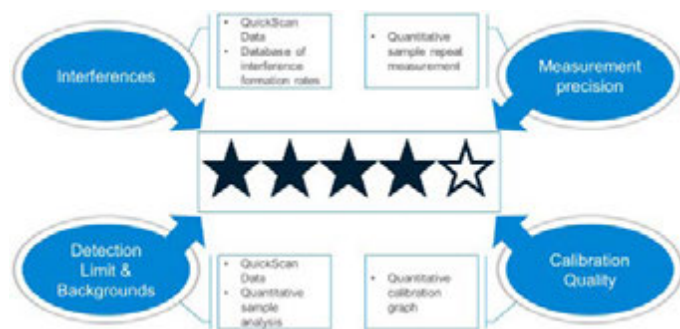
Figura 2. A classificação por estrelas do IntelliQuant usa a análise multivariada para calcular um nível de confiança para os dados quantitativos das amostras
